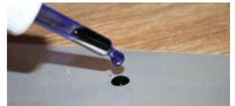
Test de tinta: colocar una gota de tinta en la superficie anodizada y pasar una tela absorbente por encima.
